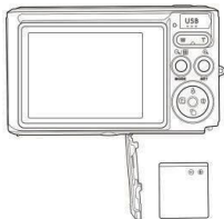
Instalacja baterii litowej
