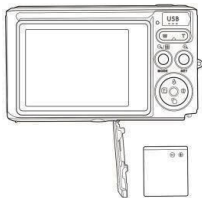
Instalar batería de litio
